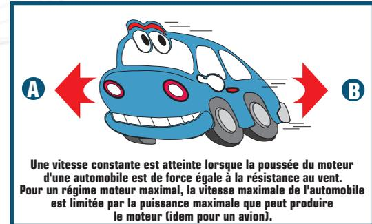
Figure 1-2. La poussée (A) d'une automobile, générée par la puissance du moteur, et la traînée (B), générée par la résistance des molécules d'air.
